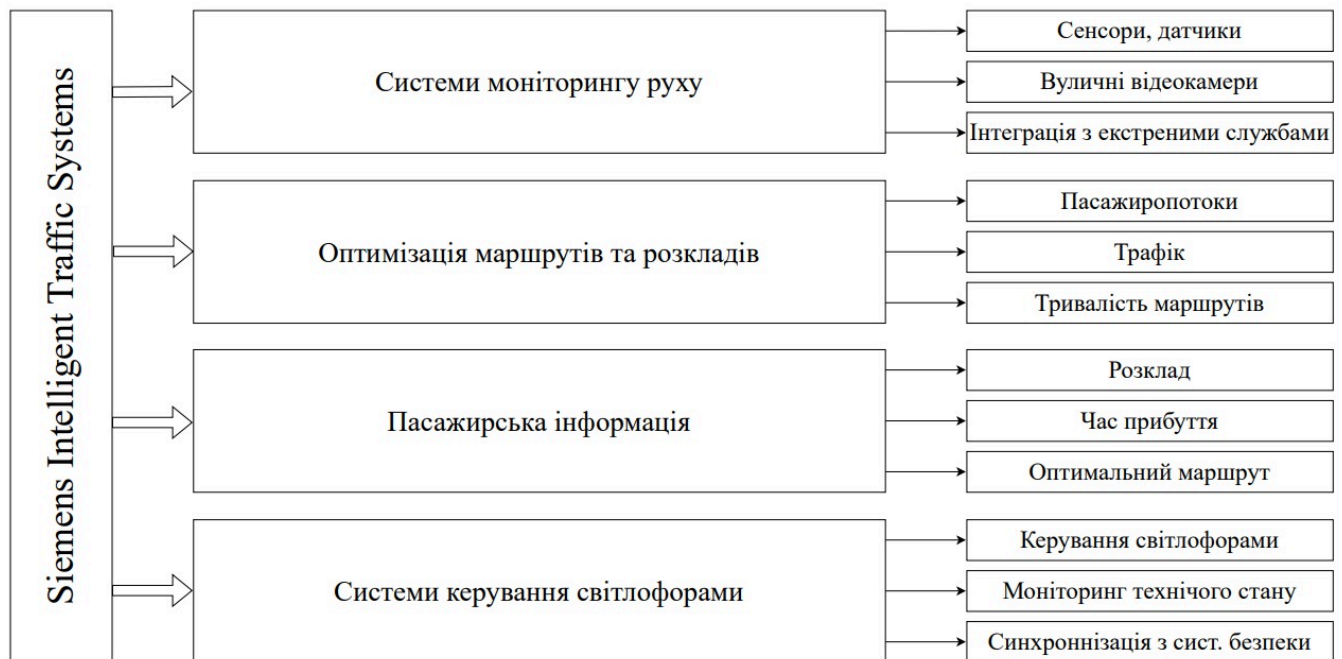
Рис. 1.6. Компоненти системи Siemens Intelligent Traffic System
