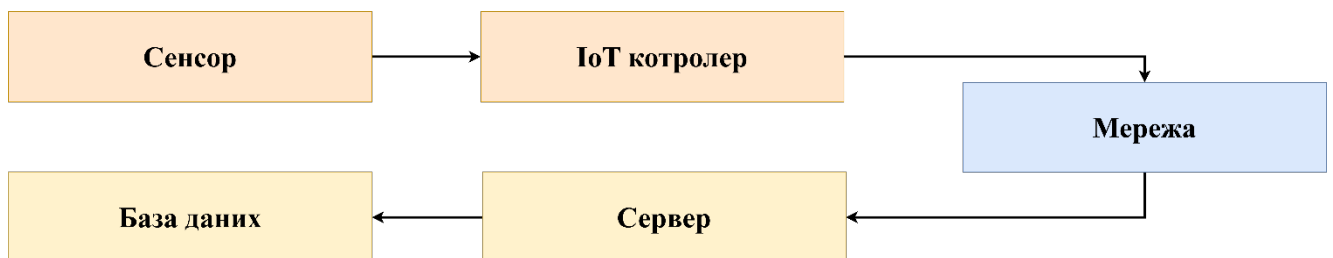
Рис. 2.1. Передача даних між IoT сенсором та сервером
