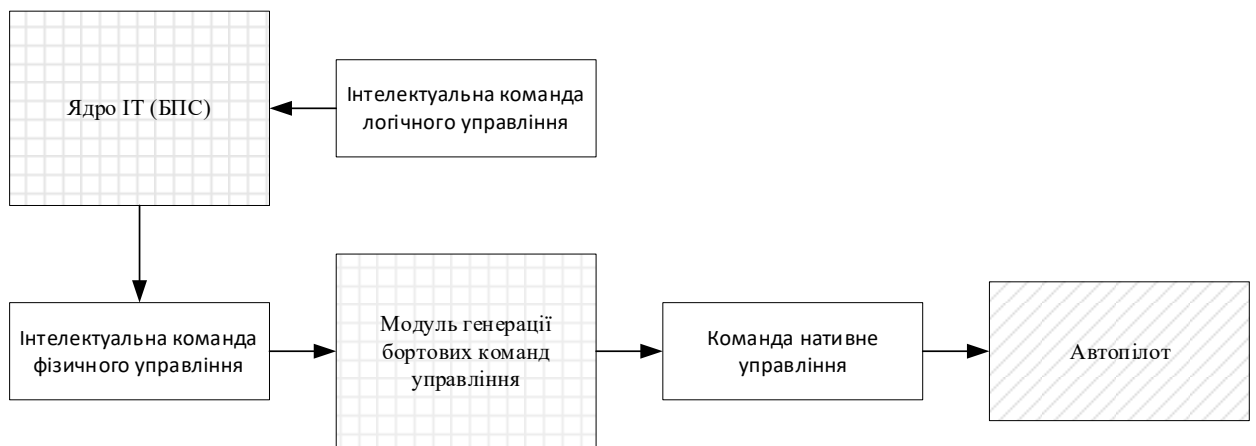
Рис. 3.7 Схема обробки інтелектуальної команди логічного управління
