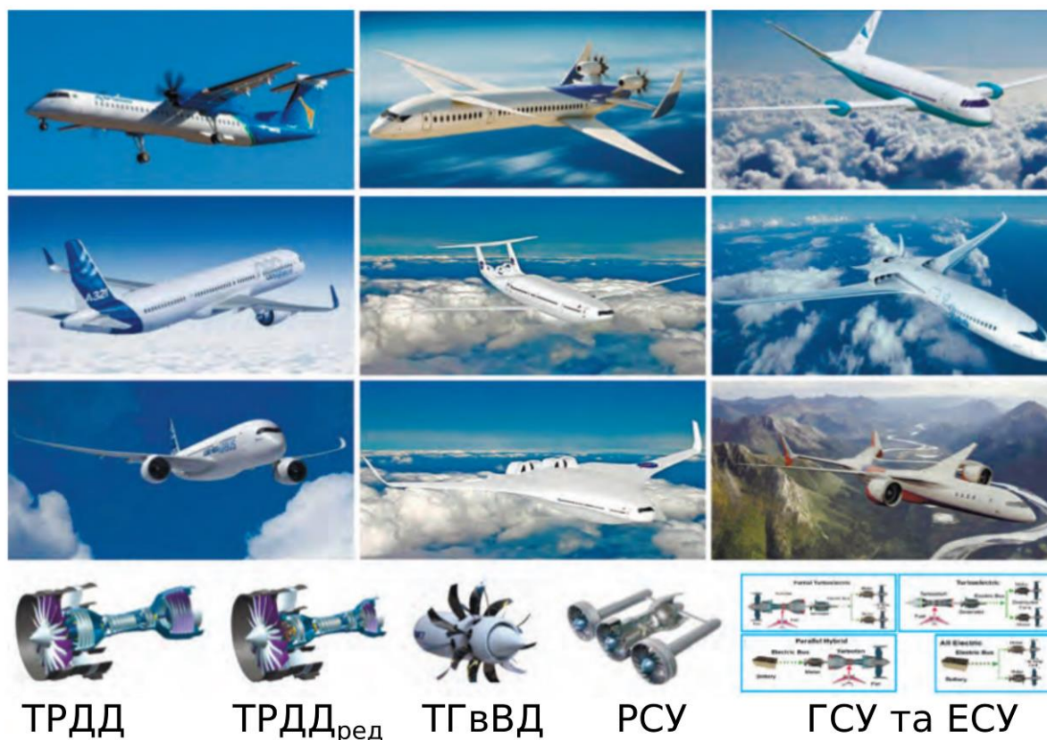
Рис. 1.6. Аеродинамічні схеми перспективних пасажирських літаків і двигуни їх силових установок [40]
