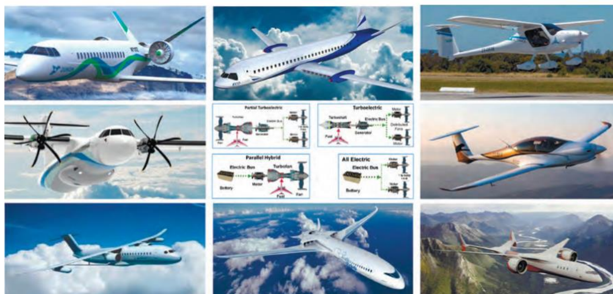
Рис. 1.7. Аеродинамічні схеми перспективних пасажирських літаків з гібридними та електричними СУ
