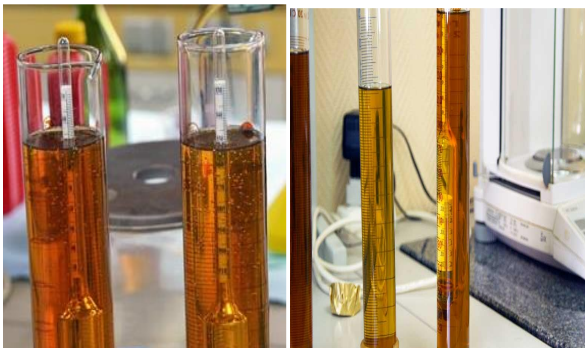
Рис.4.4. Ареометричний метод визначення густини олив
