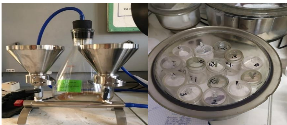
Рис.3.2. Прилад для фільтрування: а – колба для фільтрування; б – ексикатор
