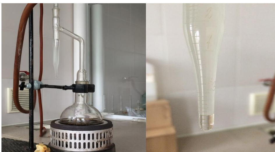
Рис. 4.1. Кількісне визначення вмісту розчиненої води в оливах
