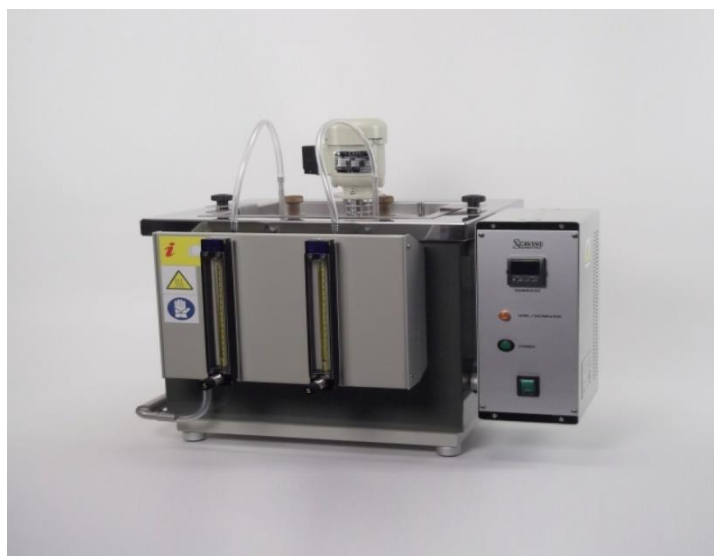
Рис. 5.5. Прилад для визначення випаровування олив за ASTM D972
