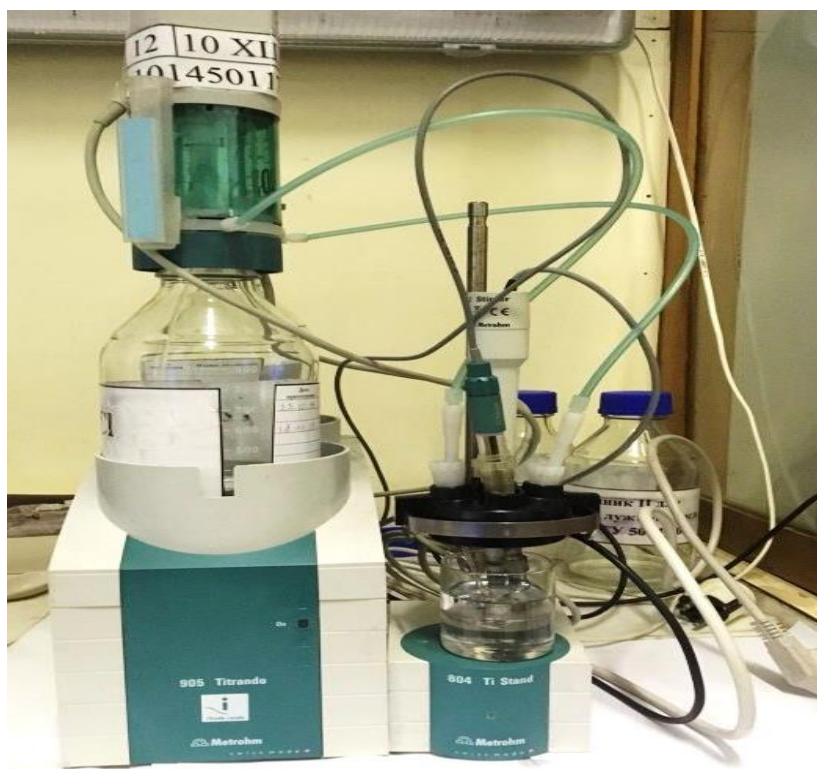
Рис. 4.10. Титратор Titrando 905 для визначення загального лужного числа ОЛИВ
