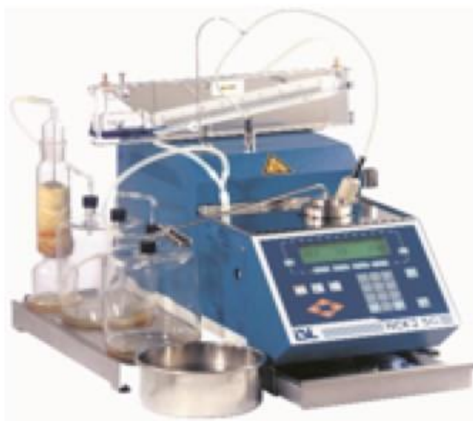
Рис. 5.4. Автоматичний прилад для визначення випаровування олив
