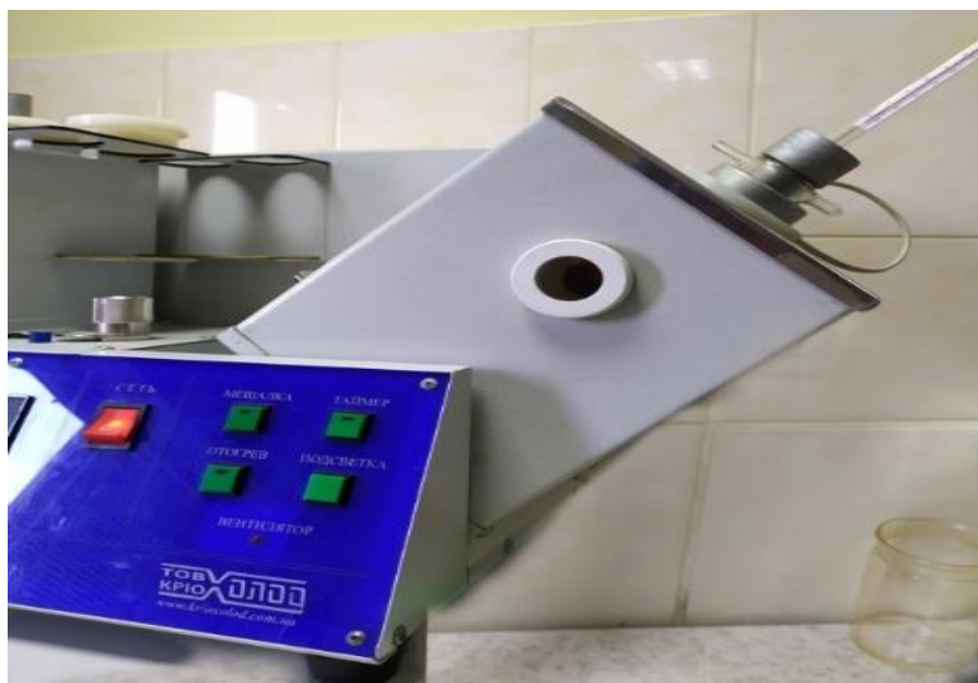
Рис.4.14. Прилад для визначення температури застигання олив
