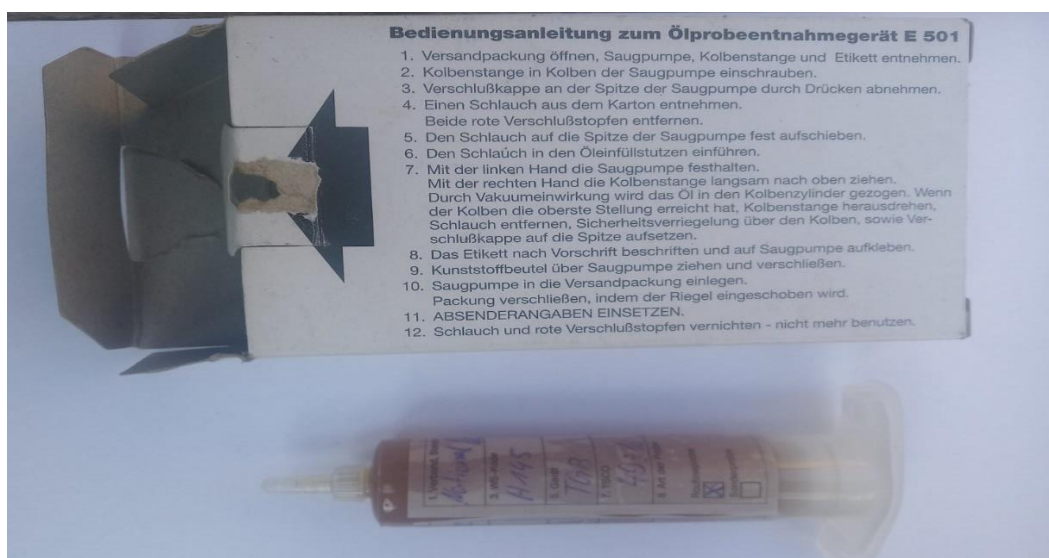
Рис.1.6. Відбір проб оливи із системи змащування гелікоптера Н-145
