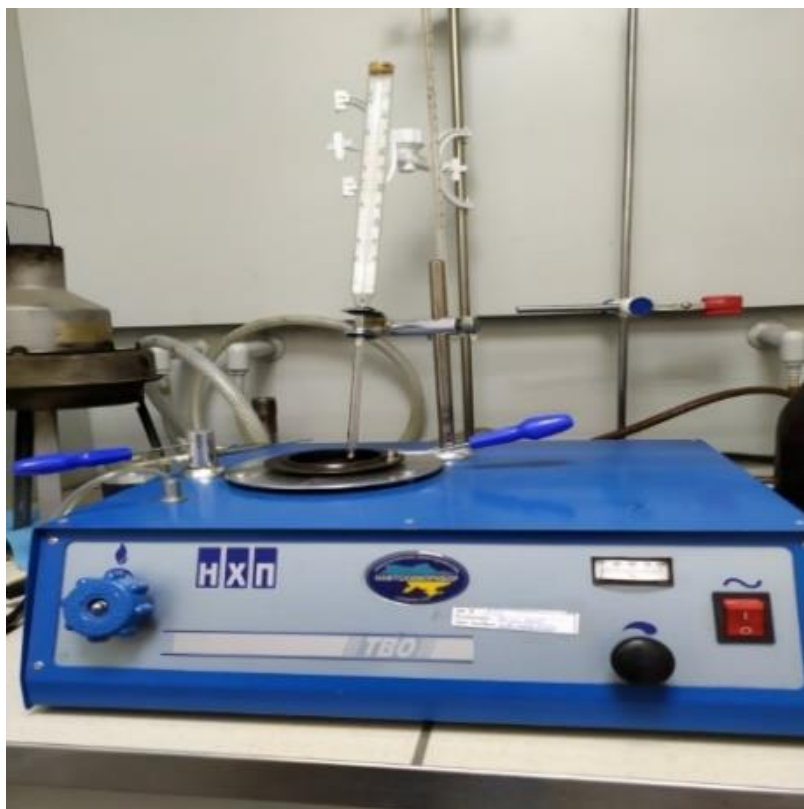
Рис.4.11. Прилад для визначення температури спалаху оливи
