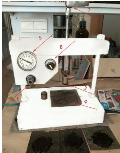
Рис. 3.9 Модифікований когезійний прилад: 1 - повітряний циліндр; 2 - шток циліндра; 3 - гумовий наконечник; 4 - пластина з толі або руберойду; 5 - манометр для вимірювання тиску в циліндрі; 6 - регулятор тиску повітря; 7 - динамометричний ключ; 8 - регулятор опускання штока циліндра
