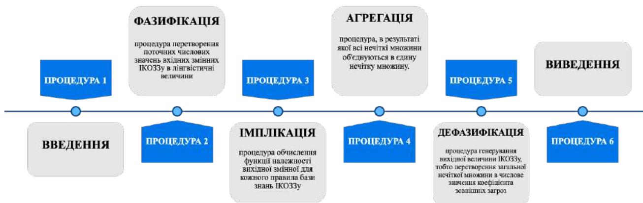
Рис. 3.3.1. Процес функціонування інтелектуального класифікатора оцінки зовнішніх загроз (ІКОЗЗ) транспортного вузла в інтегрованих системах перевезення вантажу.
