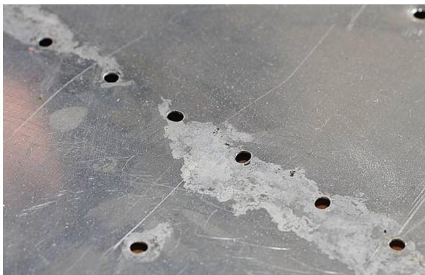
Рис. 1.4 - Поверхнева (рівномірна) корозія обшивки фюзеляжу [26].
