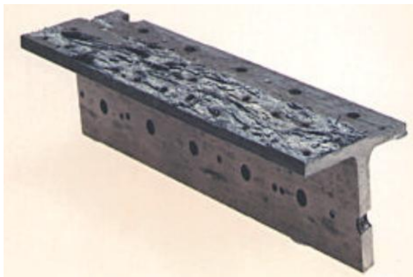
Рис. 1.5 - Розшаровуюча корозія шпангоуту, виготовленого з пресованого сплаву 7075 [27].
