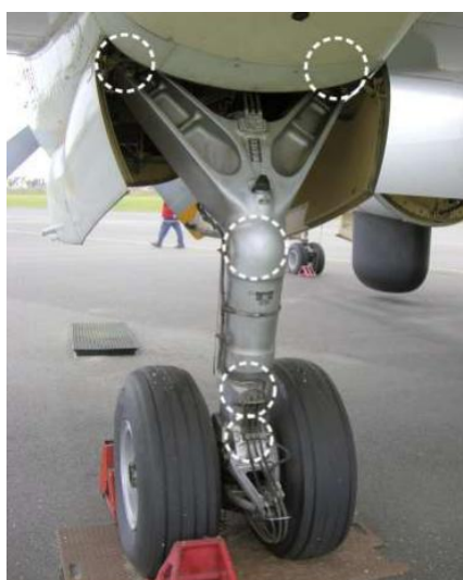
Рис. 1.9 - Зони виникнення тріщин, ініційованих корозійним розтріскуванням [31]
