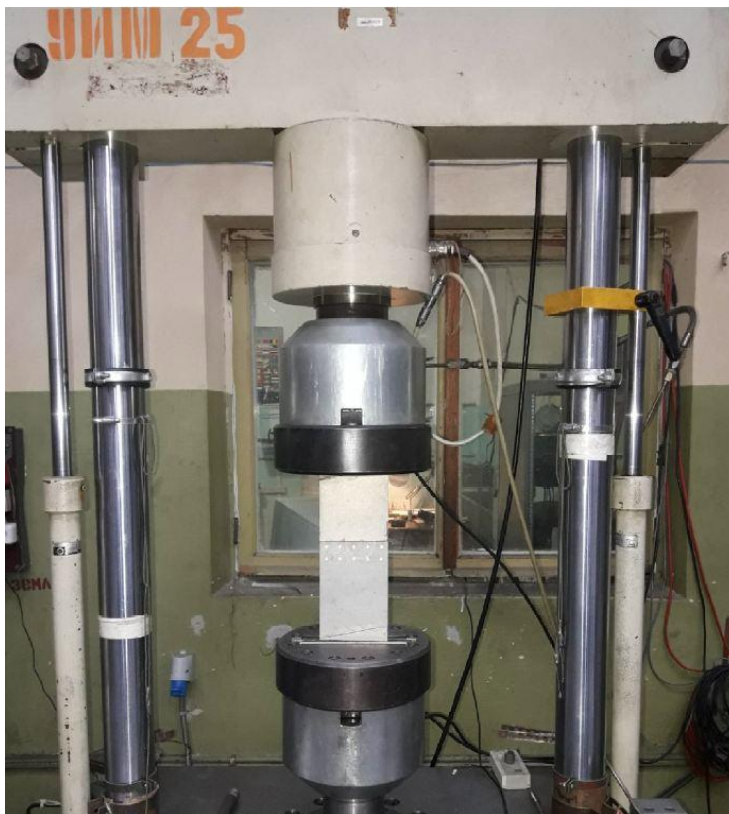
Рис. 2.3 - Випробувальна машина УИМ-25 (Schenck Hydropuls).
