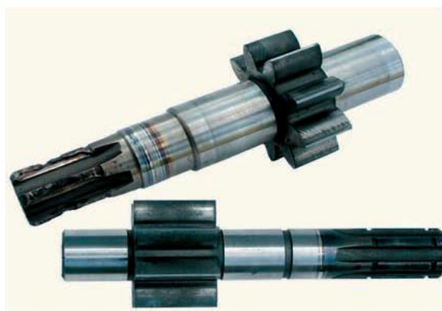
Рис. 1.3. Абразивне зношування дрібними частинками, проникаючими під манжету: утворення канавок на поверхні валу.
