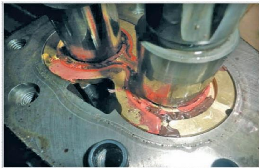
Рис. 1.4. Ознаки зношування деталей шестеренного насоса за умов обмеження гідравлічної рідини.
