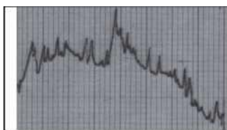
Рис. 2.18 Профілограма поверхні зуба конічної шестерні до зміцнення (Ra = 0,76 мкм)
