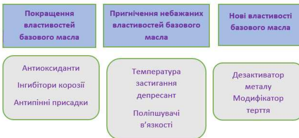
Рис. 3.1 Основні функції добавок (присадок) до мастильних матеріалів
