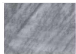
Рис. 2.20 Поверхня зуба конічної шестерні до зміцнення (Ra = 0,76 мкм) x400
