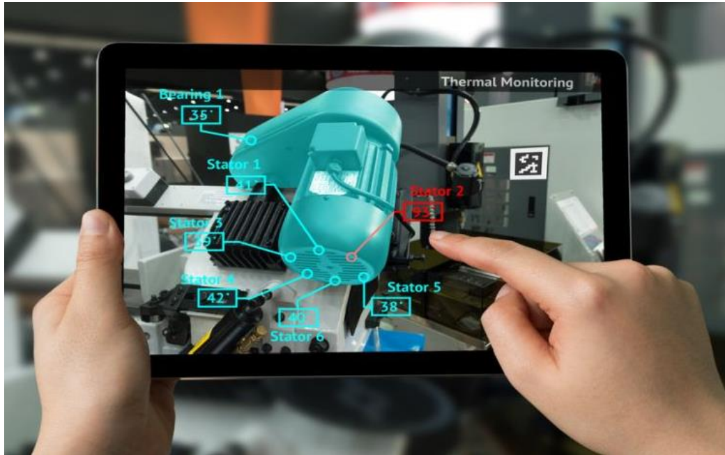
Рис. 2.2. Приклад додатку з використанням доповненої реальності для виводу елементів контролю над електричним двигуном
