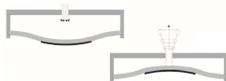
Рис. 1.6. Принцип роботи приводу штучного струменя повітря
