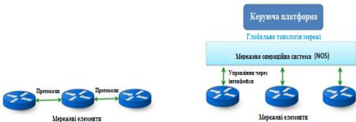
Рис. 1.18. Порівняльна схема управління мережею без SDN і з SDN
