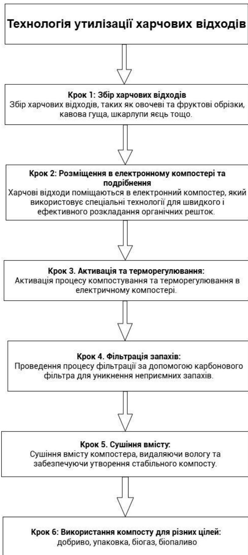
Рис. 4.1. Схема технології утилізації харчових відходів
