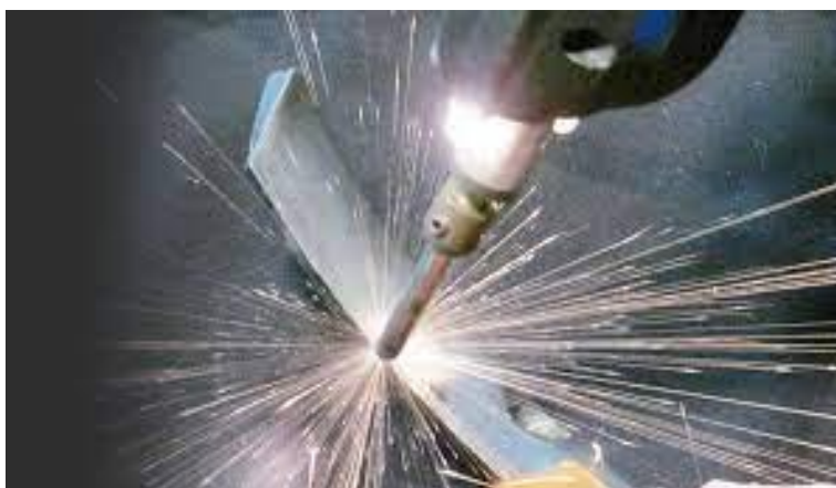
Рис. 1.5. Процес електроіскрового легування.
