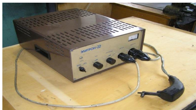
Рис. 2.2. Установка «Елітрон-22» для електроіскрового легування.
