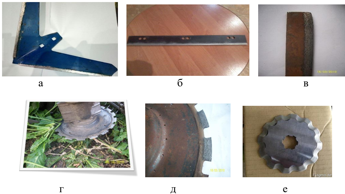
Рис. 4.20. Загальний вигляд зміцнених і відновлених деталей робочих органів СГМ композиційними електроіскровими покриттями: а - культиваторна лапа; б - ножі подрібнюючого барабану; в – ніж копача і г, д - ножі бурякозбиральних машин
