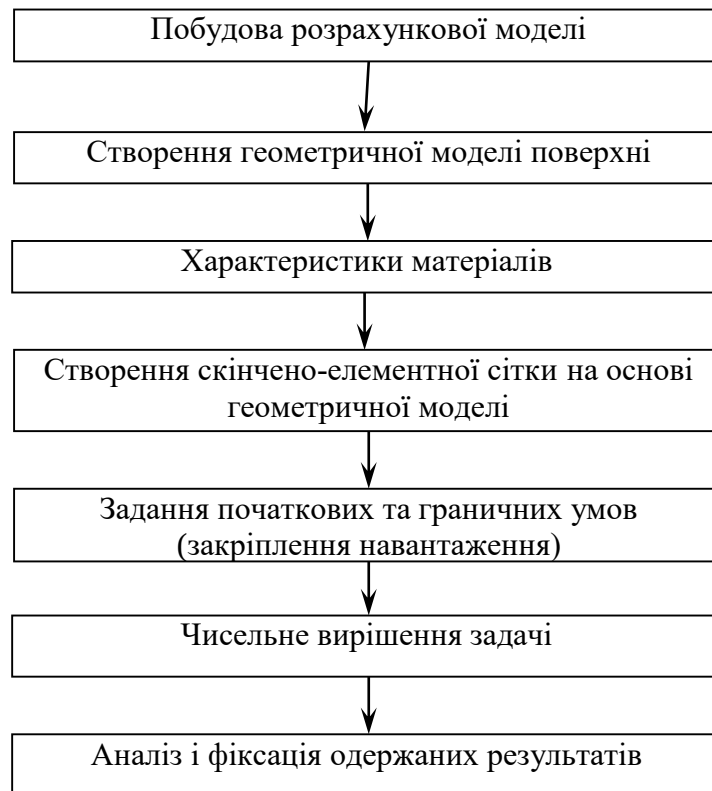
Рис. 2.4. Етапи дослідження та оцінки напружено-деформованого стану поверхонь деталей з композиційними покриттями МСЕ.
