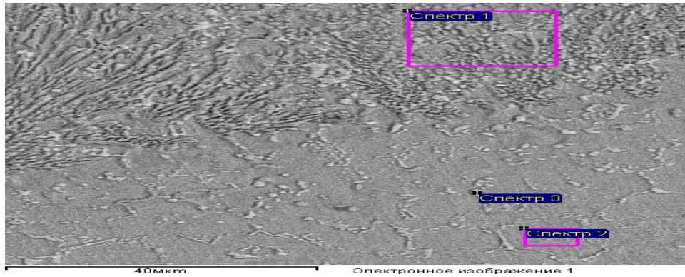
Рис. 4.9. Мікрорентгеноспектральний аналіз зразка з покриттям із сплаву X20H80.
