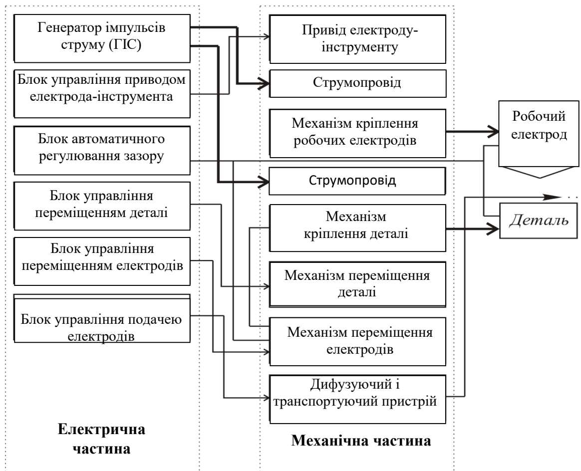
Рис. 2.3. Структурна схема установки «Елітрон-22».
