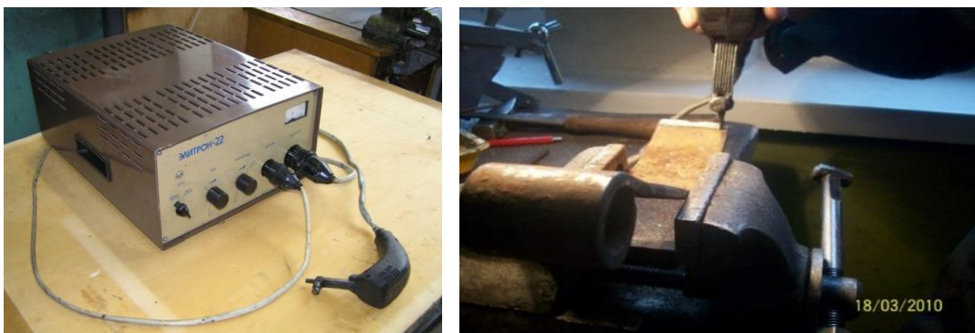
Рис. 4.3. Установка електроіскрового легування "Елітрон-22".
