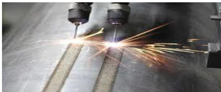
Рис. 4.1. Процес електроіскрового легування.
