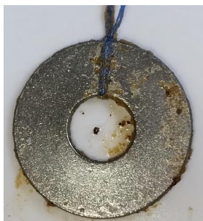
Рис. 4.9. Дослідний зразок з нержавіючої сталі у середовищі 100% Jet A-1 з наявним мікробіологічним забрудненням на 6-й день спостережень
