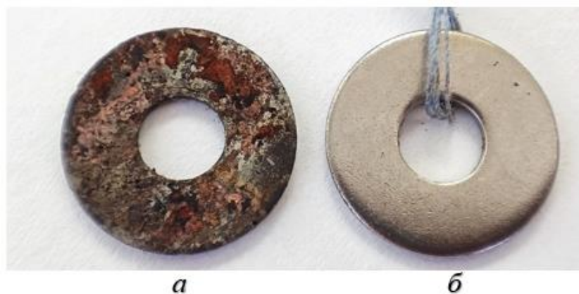
Рис. 4.14. Порівняльний аналіз стану поверхні шайб на 143-й день досліджень у середовищі 100 % ВІО: а – сталь Ст3; б – нержавіюча сталь.
