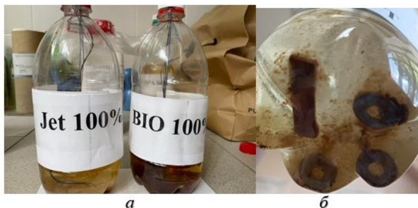
Рис. 2.3. Зразки палив для досліджень мікробіологічної корозії на конструкційні матеріали: а - загальний вигляд зразків палив; б – шайби на дні ємності із досліджуваним паливом.
