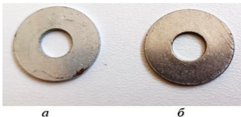
Рис. 4.5. Дослідні зразки досліджень впливу мікробіологічної корозії на конструкційні матеріали: а – сталь Ст3; б – нержавіюча сталь
