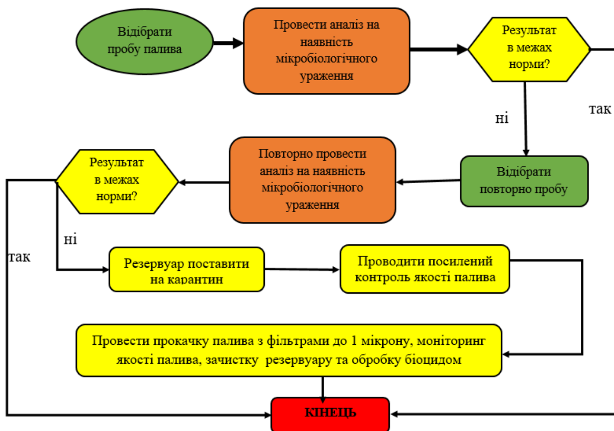
Рис. 5.3. Схема заходів контролю мікробіологічного ураження світлич нафтопродуктів та технологічного обладнання
