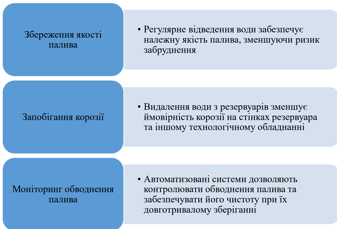
Рис. 5.2. Переваги автоматизованих систем моніторингу обводнення світлих нафтопродуктів при довготривалому зберіганні
