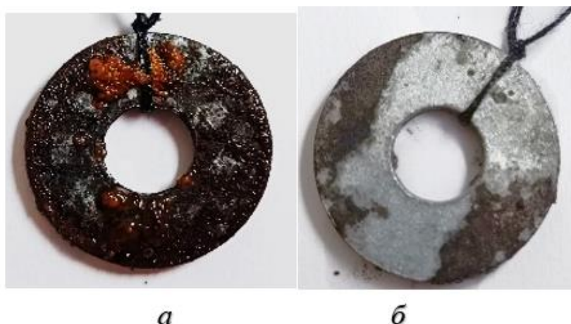
Рис. 4.11. Дослідний зразок Ст3 на 6-й день досліджень у середовищі біокомпонента з наявним мікробіологічним забрудненням:
