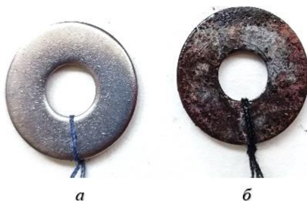
Рис. 4.13. Дослідні зразки досліджень впливу мікробіологічної корозії на конструкційні матеріали на 13-й день дослідження у середовищі 100 % ВІО:
