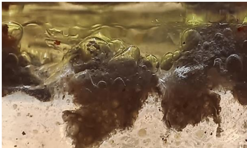
Рис. 4.24. Процес виділення газу на поверхні біоплівки у дослідному зразку дизельного палива (19-й день дослідження)
