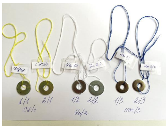
Рис. 2.4. Шайби для досліджень впливу мікробіологічної корозії на конструкційні матеріали у дизельному паливі
