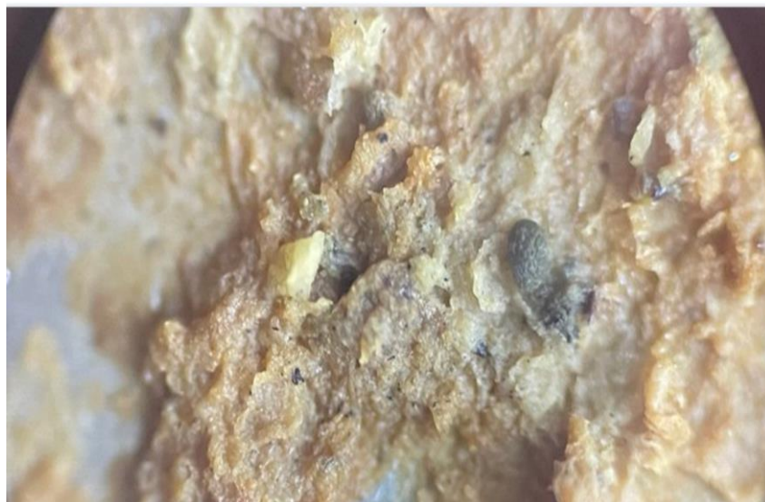
Рис. 4.16. Біоплівка на досліджуваному зразку шайби Ст3 у середовищі біокомпонента на 143 день випробувань
