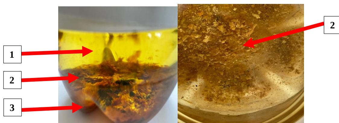
Рис. 4.7. Загальний вигляд біоплівки у досліджуваних зразках палив: 1 – паливна фаза; 2 – біоплівка; 3 – водна фаза.
