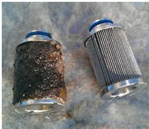
Рис. 1.10. Забруднення паливних фільтрів продуктами життєдіяльності мікроорганізмів
