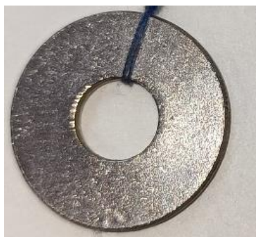
Рис. 4.10. Дослідний зразок з нержавіючої сталі у середовищі біокомпонента з наявним мікробіологічним забрудненням на 6-й день спостережень
