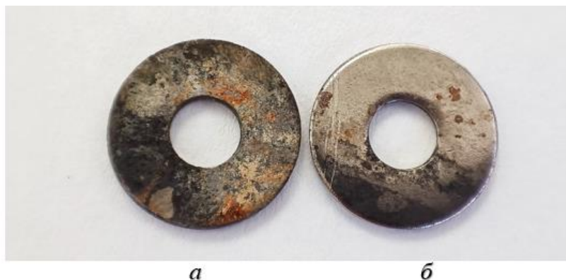
Рис. 4.15. Дослідні зразки досліджень впливу мікробіологічної корозії на конструкційні матеріали на 143-й день дослідження у 100 %: Jet A-1:
