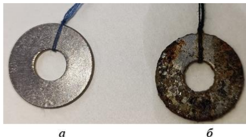
Рис. 4.12. Дослідні зразки для визначення впливу мікробіологічної корозії на конструкційні матеріали на 13-й день у середовищі Jet A-1:
