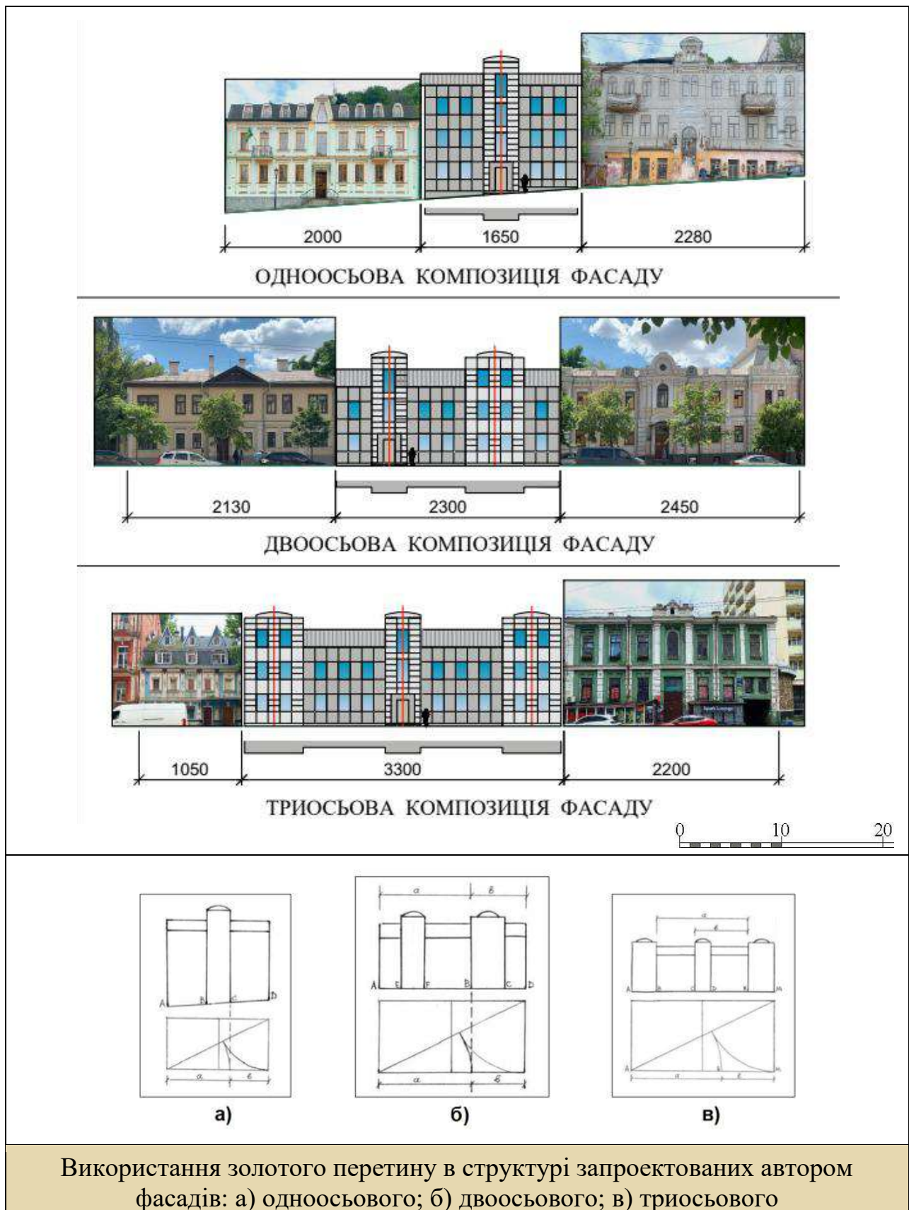
Рис. 3.8 Використання різних типів схематичних моделей структурного рішення фасадів в історичній забудові (розробка автора).
