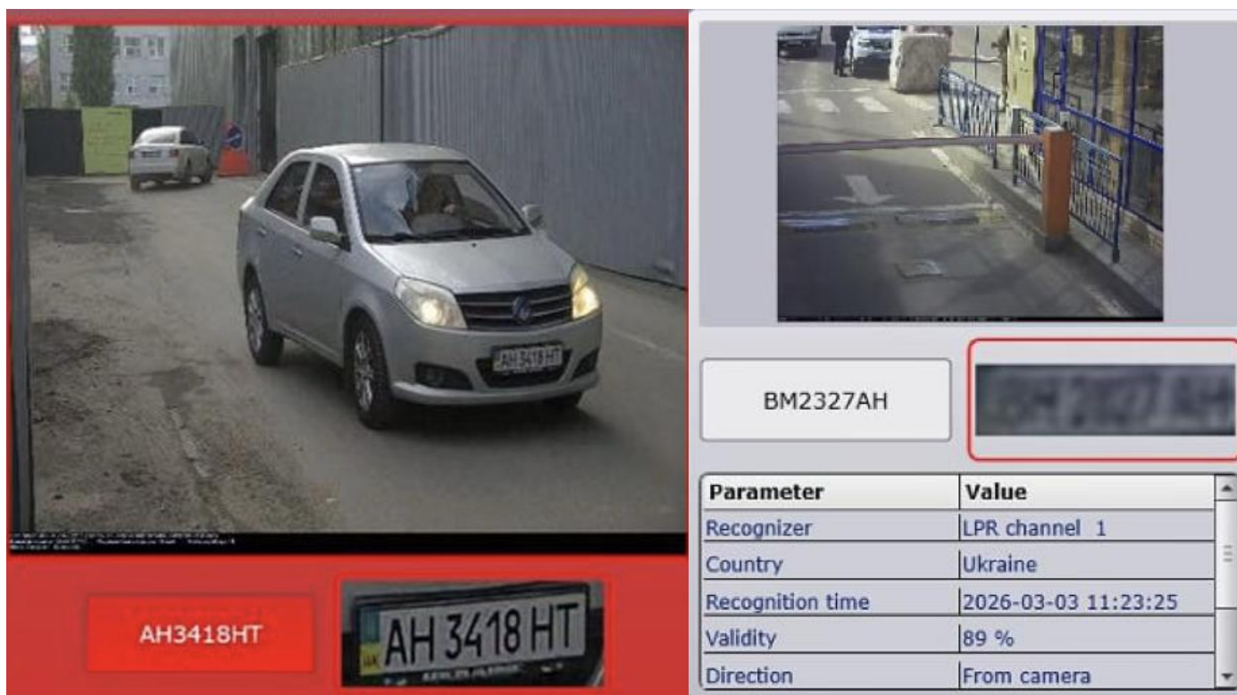
Рис. 1.7. Порівняння розпізнавання номерів з двома різними моделями аналітики
