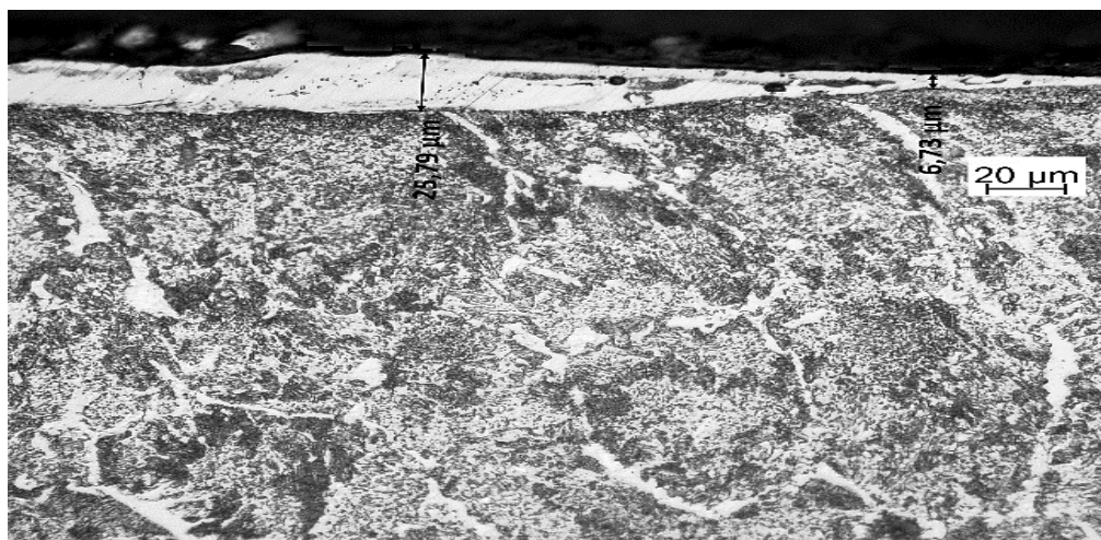
Рис. 3.5. Фрагменти мікроструктури сталі 45 (поперечний переріз) з нанесеним ЕІП сталі Р18.
