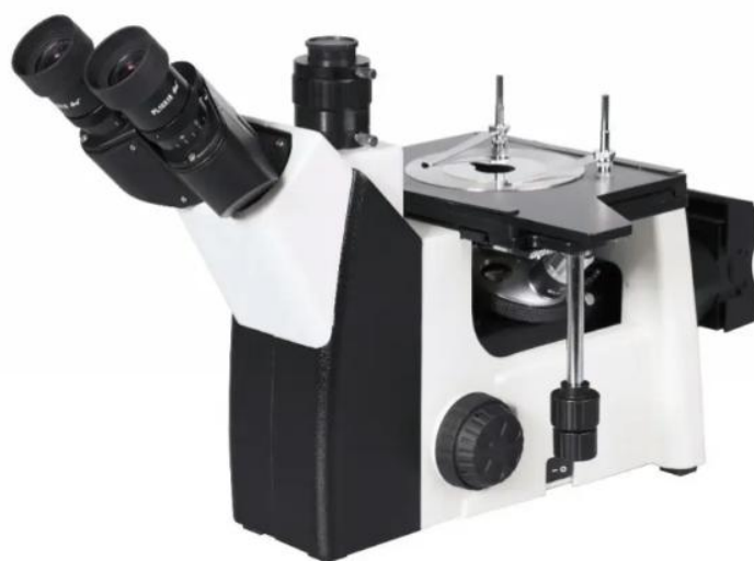
Рис. 2.6. Зовнішній вигляд мікроскопу для металографічних досліджень IE200M.
