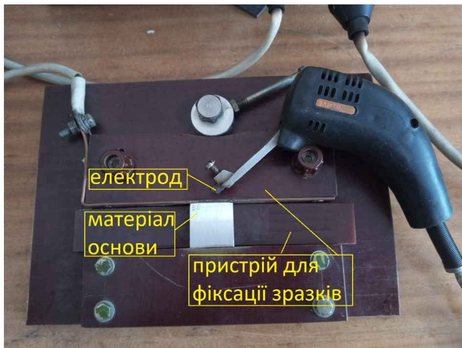
Рис. 2.1. Загальний вид установки для електроіскрового легування (а) та пристрій для фіксації зразків для ЕІЛ.
