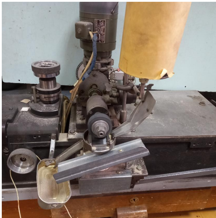
Рис. 2.2. Загальний вид установки для випробування на абразивну стійкість.
