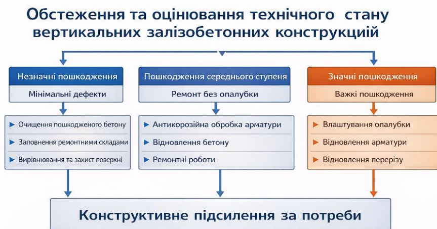
Рисунок 4.1 – Блок–схема вибору заходів з відновлення та підсилення вертикальних залізобетонних елементів
