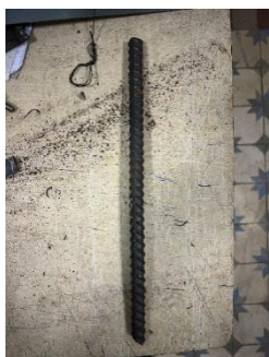
Рисунок 3.12 – Відібрані арматурні стрижні
