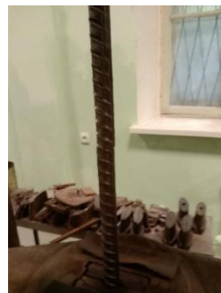
Рисунок 3.13 – Зразок арматурного стрижня, закріпленого у випробувальній машині
