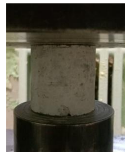
Рисунок 3.10 – Оброблені зразки кернів, готові до випробування у гідравлічному пресі ПГ–100
