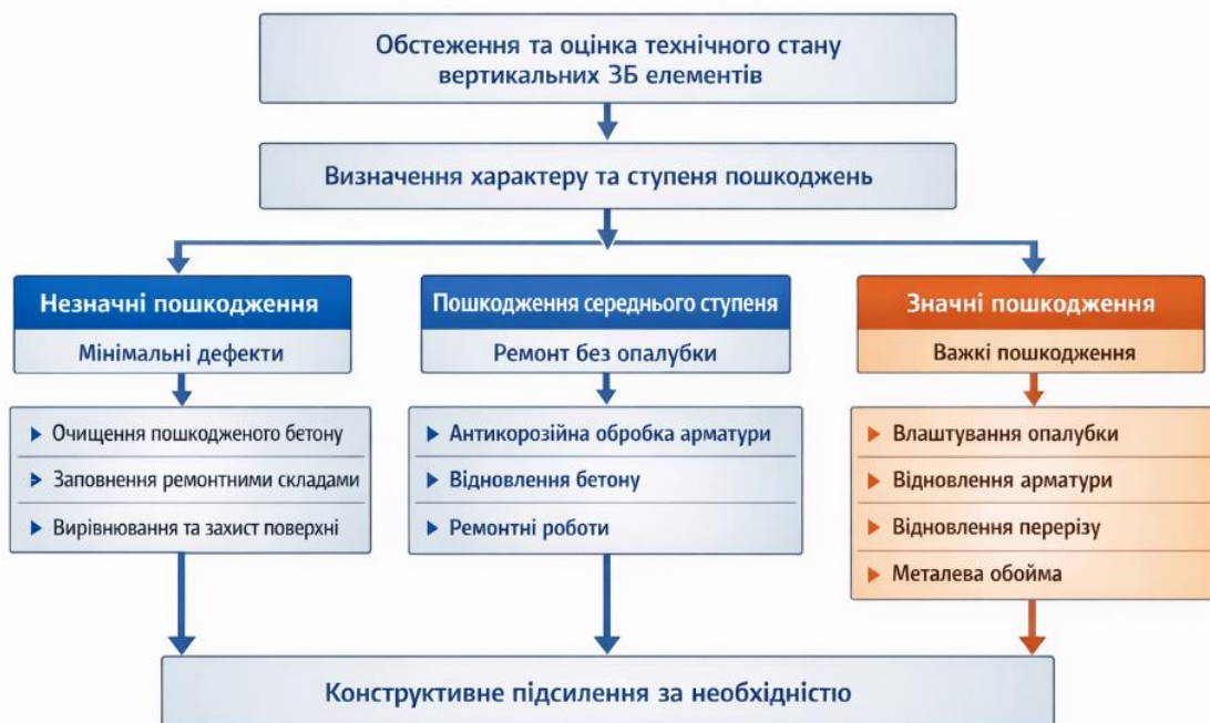
Рисунок 4.1 - Блок – схема вибору заходів з відновлення та підсилення вертикальних залізобетонних елементів
