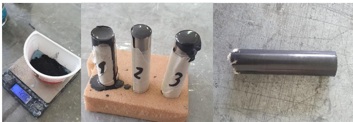
Рис 2.1. Технологічна послідовність отримання лабораторних зразків антифрикційних матеріалів на основі реактопластичної матриці.
