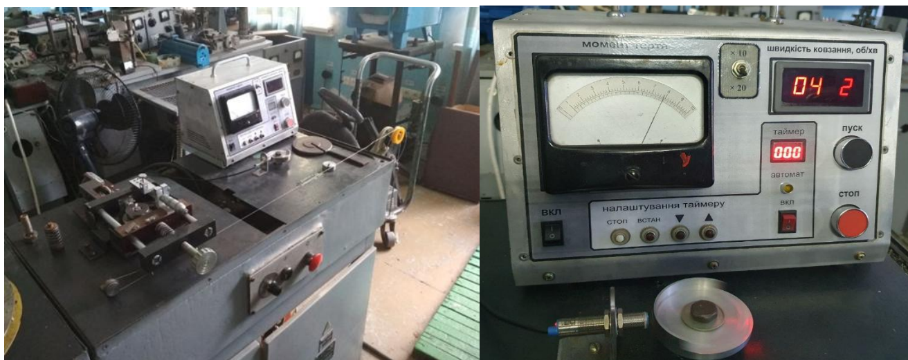
Рис. 2.8 Загальний вигляд експериментальної трибометричної установки та блоку управління
