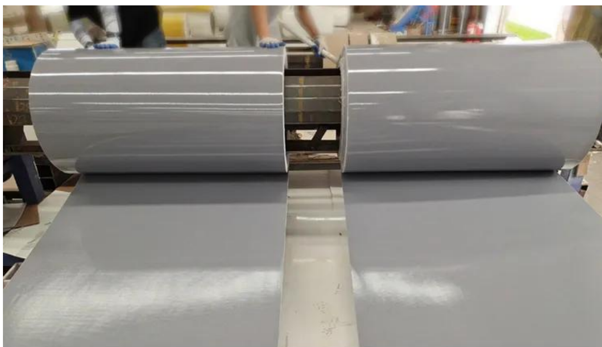
Рис 1.2. Армований скловолокном полістирол (PS)
