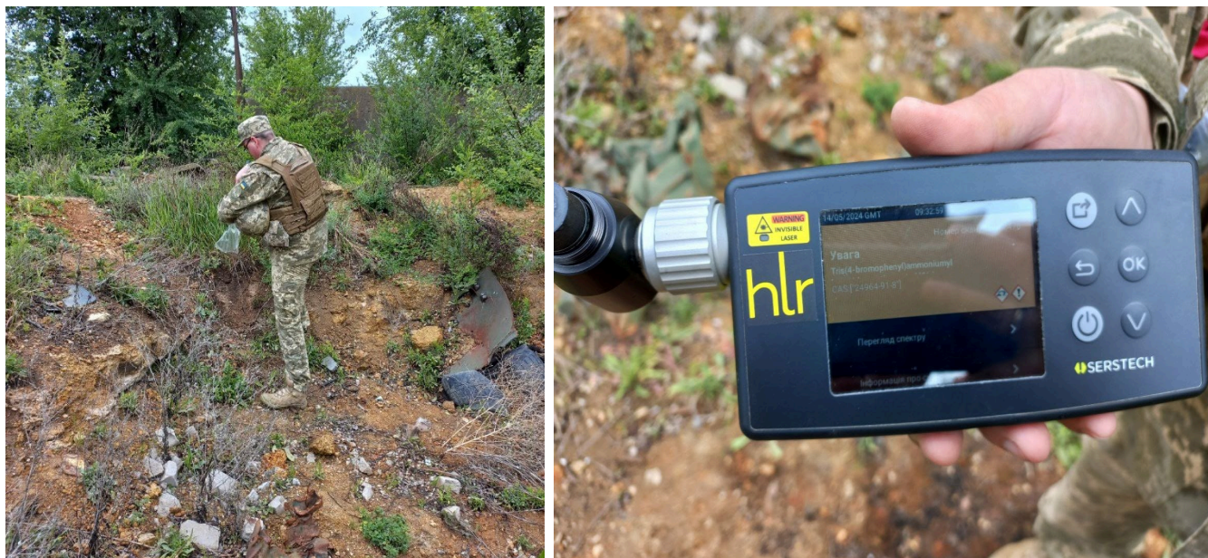
Рис. 21. Капонір (зона контактного бою 2022 року), локація відбору проб ґрунту. Примітка: за результатами експрес-аналізу портативним раман-спектрометром Serstech Arx, у всіх відібраних зразках ідентифіковано стійкий спектральний маркер: гексахлороантимонат трис(4-бромфеніламонію) (Tris(4-bromophenyl)ammoniumyl hexachloroantimonate, CAS № 24964-91-8).
