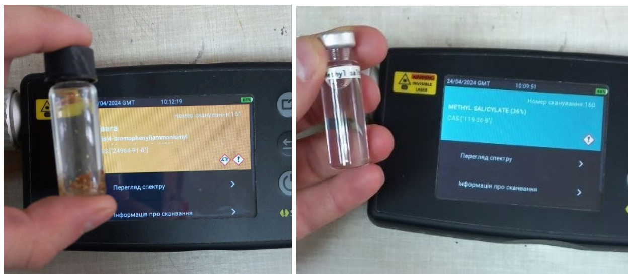
Рис. 27. Проведення валідаційного аналізу у лабораторних умовах на раман-спектрометрі. На рисунку А вказано частинки ґрунту, забруднені вибуховими речовинами, на рисунку Б – контрольний зразок з метою верифікації оцінки роботи приладу.
