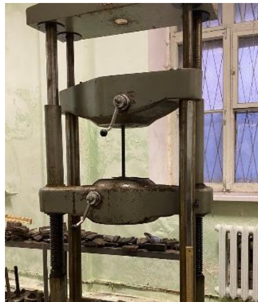
Рисунок 3.24 – Випробування зразків арматурних стрижнів на випробувальній машині ZD-40
