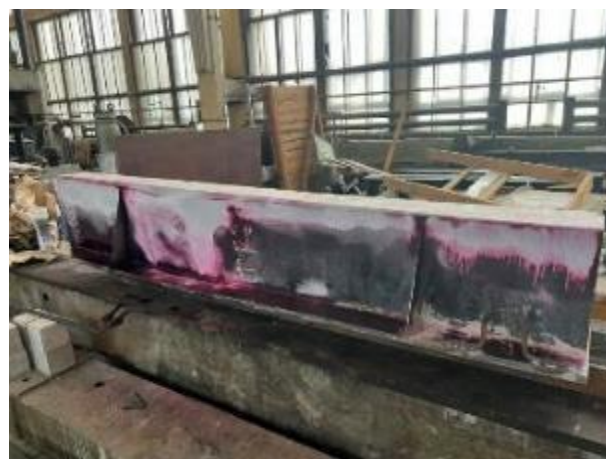
Рисунок 3.33 – Виконання кольорової дефектоскопії на металевих листах сталезалізобетонних зразків
