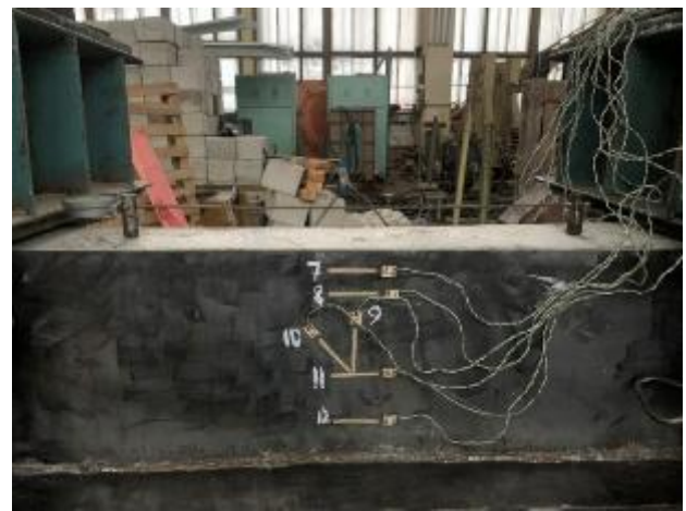
Рисунок 3.16 – Електротензорезистори встановлені, на досліджуваному зразку
