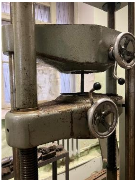
Рисунок 3.23 – Випробування зразків металевих пластин на випробувальній машині ZD-40
