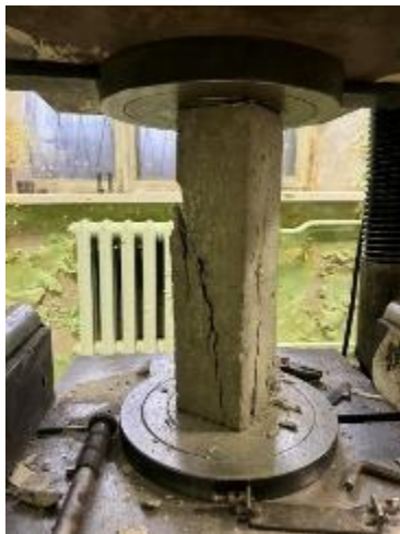
Рисунок 3.20 – Загальний вигляд бетонної призми у пресі ПГ–100: а – до випробування; б – після випробування
