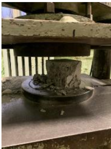
Рисунок 3.19 – Загальний вигляд бетонного кубика у пресі ПГ-100: а – до випробування; б – після випробування
