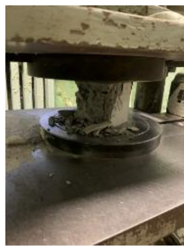
Рисунок 3.19 – Загальний вигляд бетонного кубика у пресі ПГ-100: а – до випробування; б – після випробування
