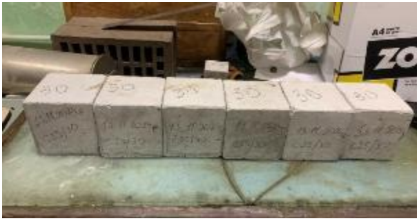
Рисунок 3.8 – Зразки бетонних кубиків
