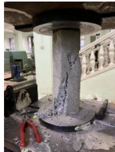
Рисунок 3.20 – Загальний вигляд бетонної призми у пресі ПГ–100: а – до випробування; б – після випробування
