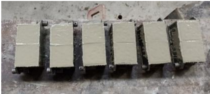
Рисунок 3.12 – Виготовлення бетонних кубів
