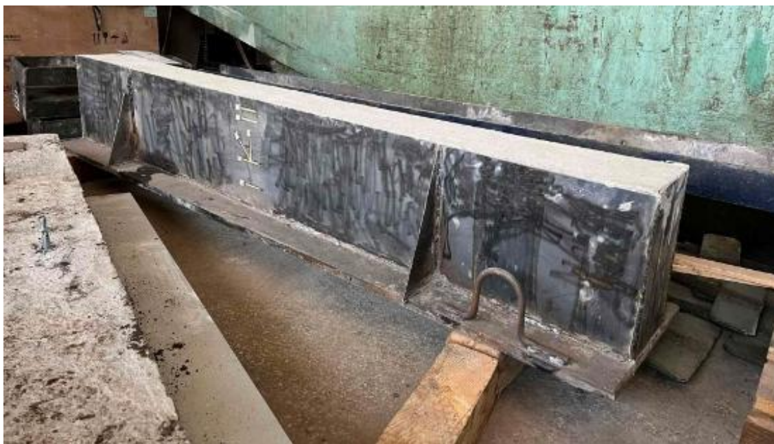
Рисунок 3.7 – Загальний вигляд сталезалізобетонної балки перед випробуванням
