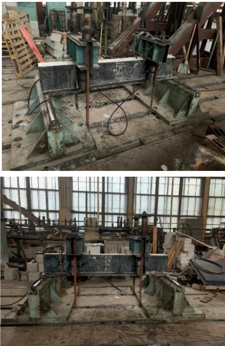
Рисунок 3.27 – Зразки сталезалізобетонних балок, готові до випробування
