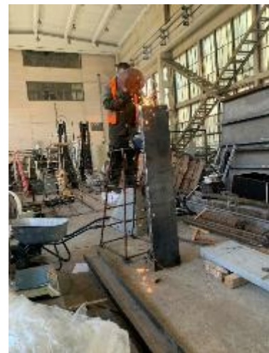
Рисунок 3.5 – Виконання з'єднання листів між собою за допомогою ручного електродугового зварювання
